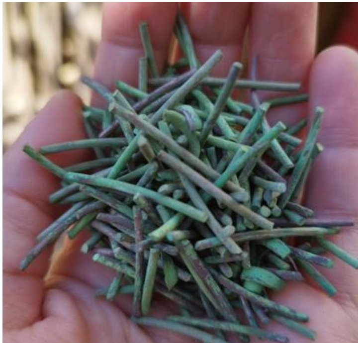
Εικόνα 4-40: Σχηματισμός φιλμ οξειδίου του χαλκού στην επιφάνεια του μετάλλου
