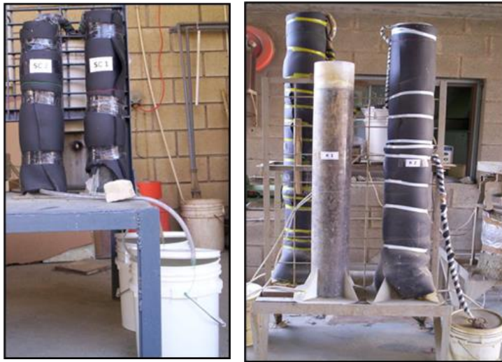
Εικόνα 4-37: Πιλοτικές δοκιμές εκχύλισης χαλκούχου μεταλλεύματος εν θερμώ
