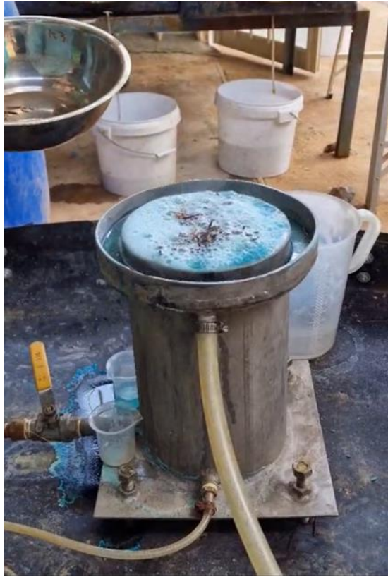
Εικόνα 4-39: Αντιδραστήρας για τη διάλυση του scrap σε πιλοτική κλίμακα
